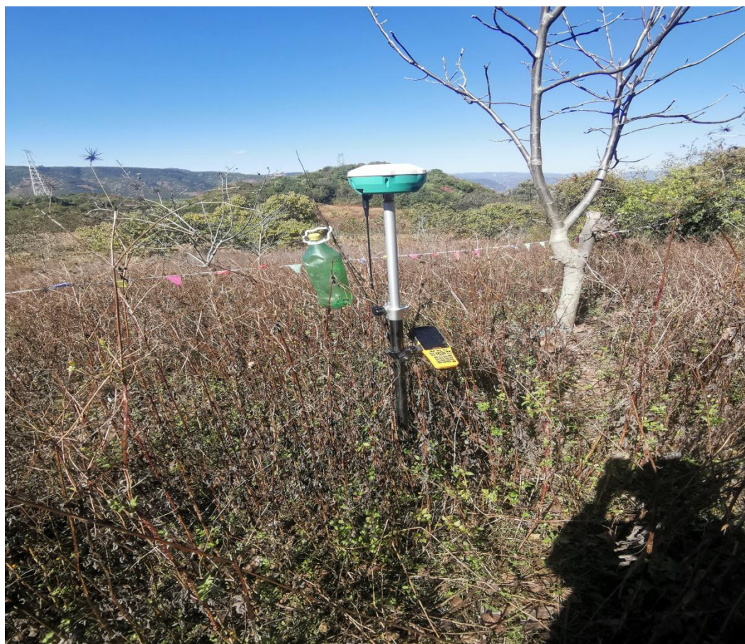
图 8.2-3 地下水监测井现场定测 (ZK1)
