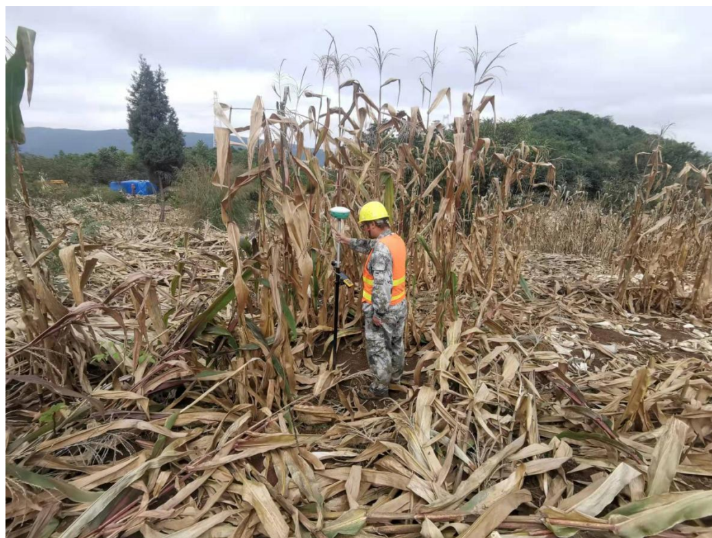
图 8.2-4 地下水监测井现场定测 (ZK2)
